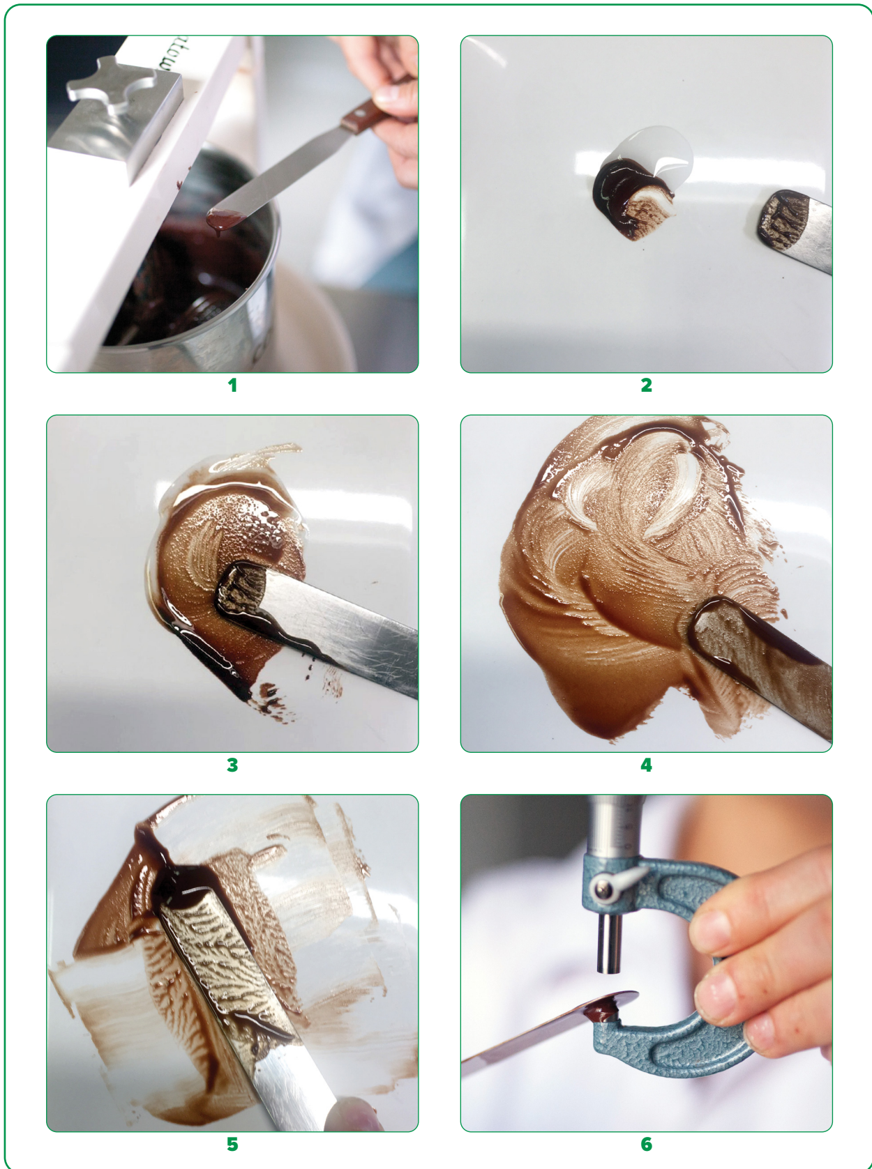
Figura 38. Procedura di preparazione della massa di cacao con olio minerale, per la misurazione delle dimensioni delle particelle con un micrometro (Bioversity International, Archila, 2022).
