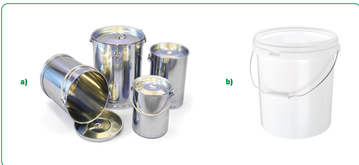
Figura 46. Esempio di (a) contenitori di stoccaggio in acciaio inox e (b) in plastica per la preparazione del campione composto da campioni primari o incrementali. I contenitori per la conservazione devono essere dotati di coperchi per ridurre al minimo la perdita/l'aumento di umidità, l'assorbimento di odori estranei/anomali e l'infestazione di insetti e/o roditori. ( sampling.com ; mannlakeltd.com ).
