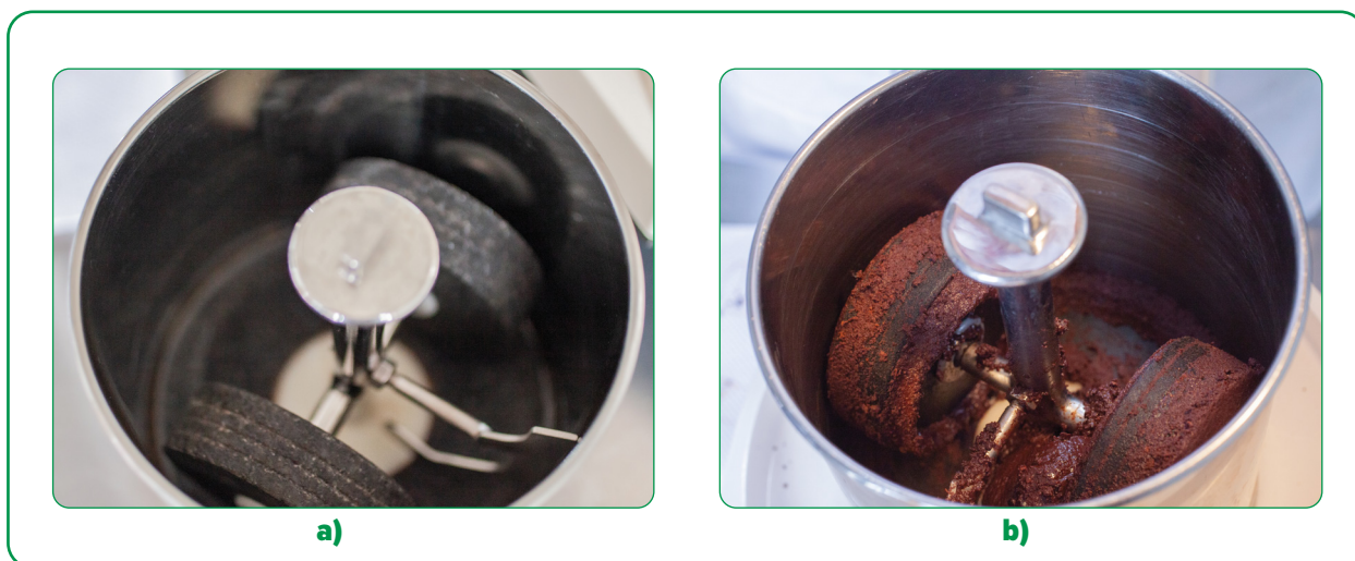
Figura 70. All'interno della molazza: a) vista dell'assemblaggio del macinino in pietra all'interno della ciotola di pietra vuota; b) vista del tamburo della molazza durante la trasformazione della granella di cacao in massa di cacao. ( chocolatemelangeur.com ; chocolatealchemy.com ).
