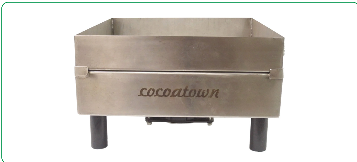
Figura 61. Esempio di teglia di raffreddamento con ventola applicata sul ( cocoatown.com ).
