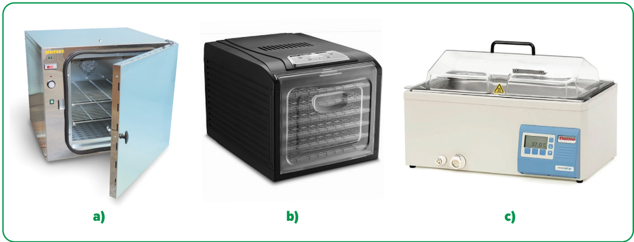
Figura 95. Esempi di apparecchiature di riscaldamento per la valutazione sensoriale della massa di cacao: a) forno per il riscaldamento ( matest.com ); b) essiccatore alimentare ( gourmia.com ); c) bagnomaria da laboratorio ( fishersci.es ).
