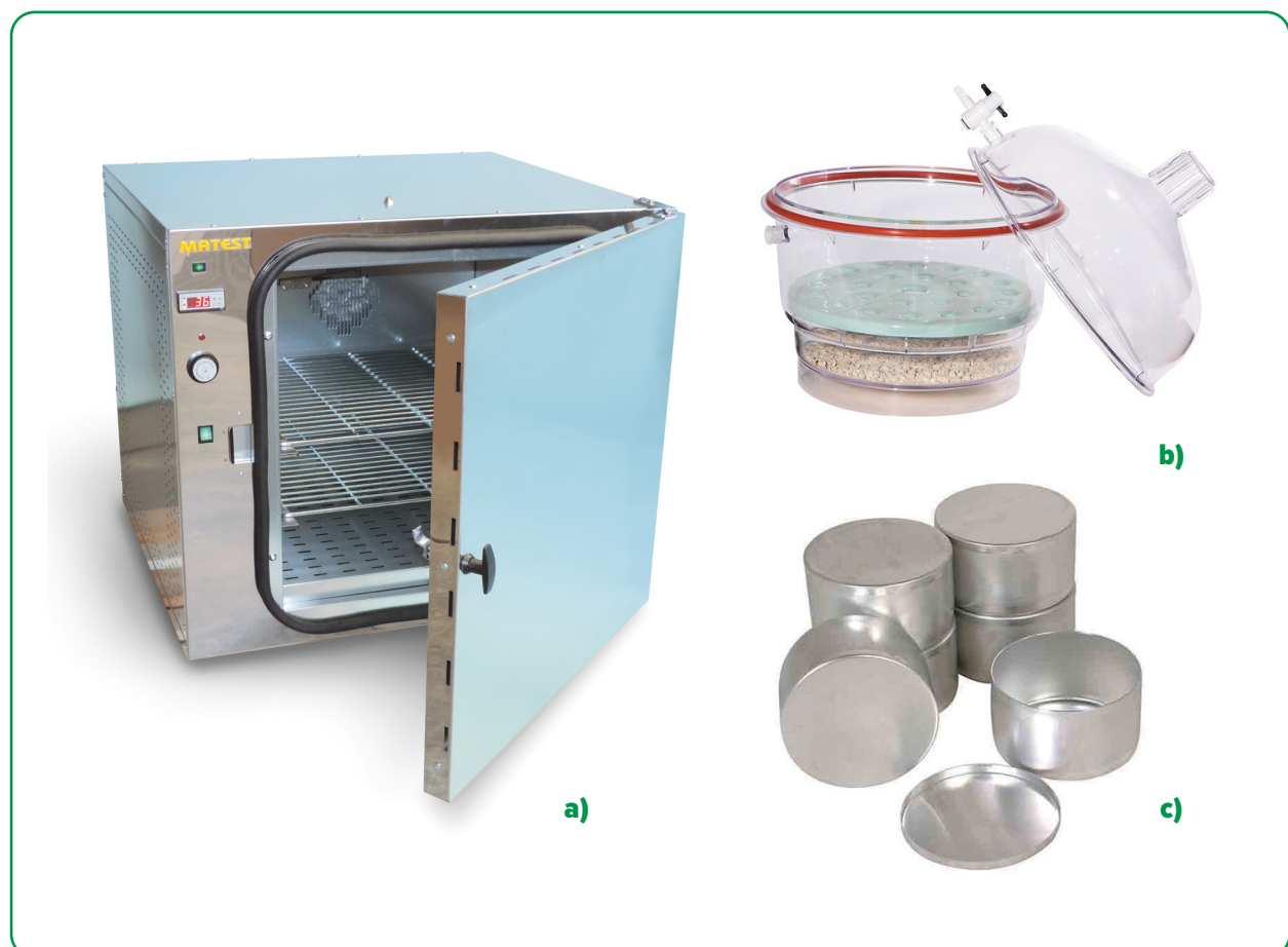
Figura 48. a) forno, b) essiccatore e c) piatti metallici, per il significato del contenuto di umidità con il metodo dell'essiccazione in forno ( matest.com ; coleparmer.co.uk ; certifiedmtp.com ).
