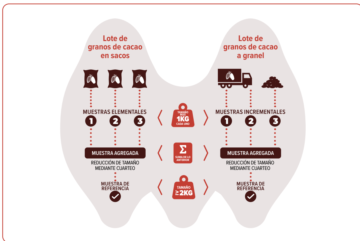
Figura 3. Representación esquemática del proceso de muestreo y tipos de muestras (basado en: ISO, 2292:2017 e ISO, 2451:2017).
