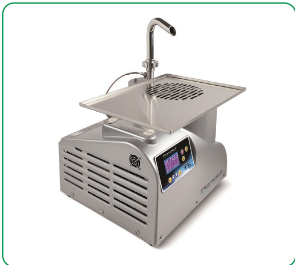
Figura 83. Atemperadora totalmente automática para pequeñas cantidades. ( pomati.it ).
