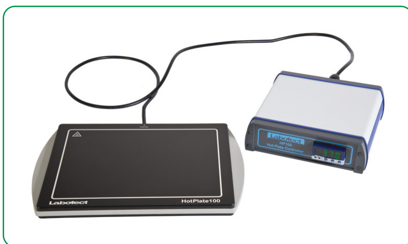
Figura 93. Ejemplo de un equipo de calentamiento para la evaluación sensorial de la masa de cacao: una placa de calentamiento ( labotect.com ).
