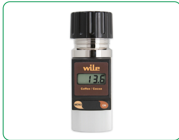
Figura 51. Medidor de humedad de café y cacao Wile ( wile.fi ).
