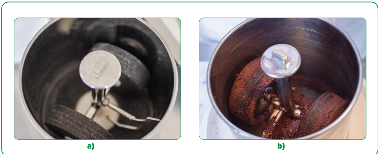
Figura 70. Interior del melanger : a) vista del conjunto del molino de piedra dentro del cuenco de piedra vacío; b) vista del cuenco del melanger mientras se muelen los nibs de cacao para convertirlos en masa de cacao. ( chocolatemelangeur.com ; chocolatealchemy.com ).
