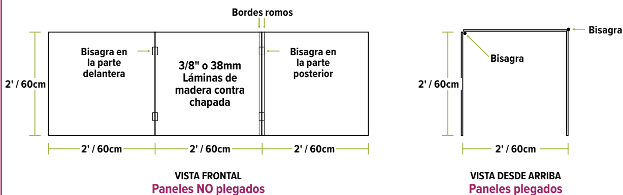
Figura 14. (Arriba) Zonas sensoriales equipadas con mesas y tabiques móviles construidas con madera no resinosa o contrachapada pintada con colores neutros. (Abajo) Ejemplo de esquema de construcción de cabinas sensoriales portátiles (Alejandro Anzueto/Universidad del Valle de Guatemala; https://thelabinthebag.com y Lawless y Heymann, 2010).
