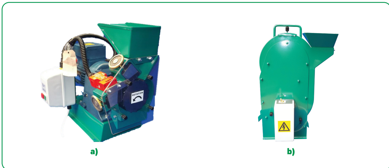
Figura 64. Equipo de acero inoxidable CAPCO para a) quebrar y b) descascarillar granos de cacao ( capco.co.uk ).
