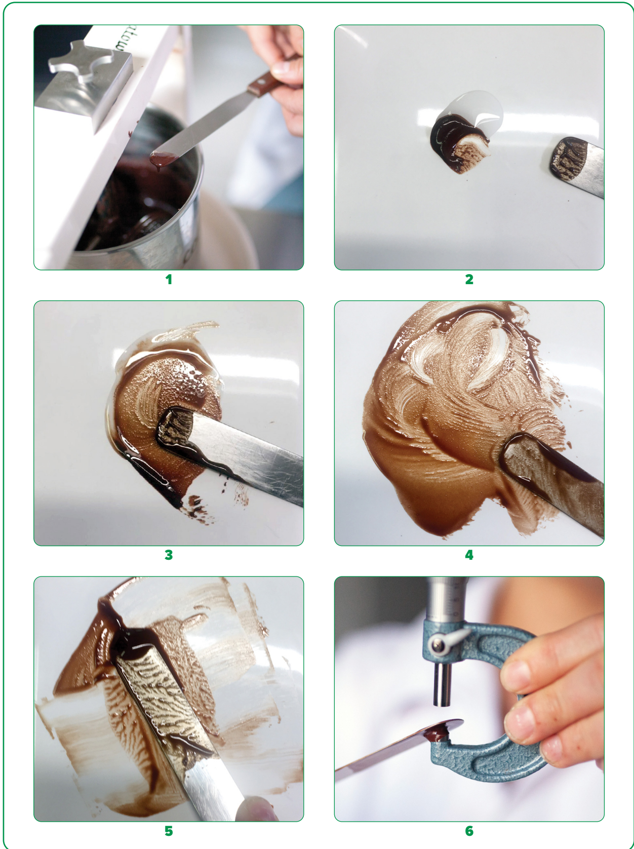
Figura 38. Procedimiento para preparar masa de cacao usando aceite mineral, para medir el tamaño de partícula con un micrómetro (Bioversity International, Archila, 2022).
