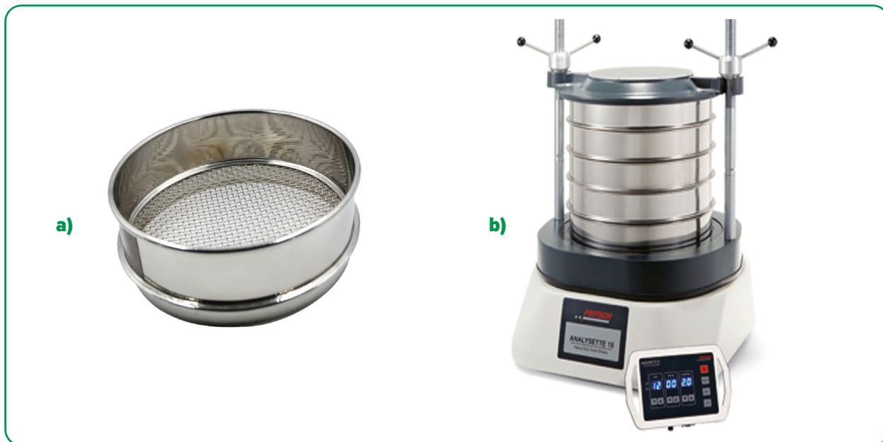
Figura 53. a) Tamiz de ensayo para separar los granos de cacao de las partículas de suciedad; b) tamiz vibrador mecánico para medir y analizar la distribución del tamaño de los granos ( lavallab.com ).
