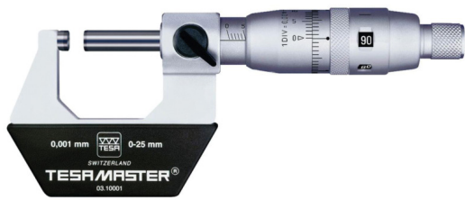
a) Micrometro analogico ad alta precisione
