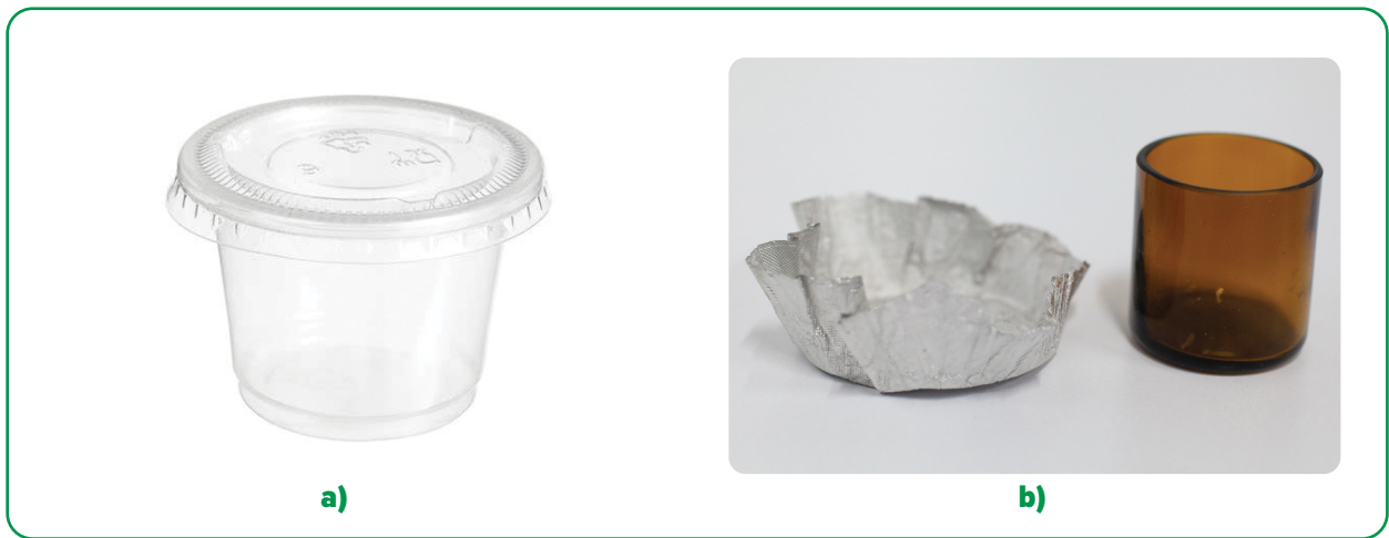
Figura 91. Esempio di coppette da 28ml: a) plastica con coperchio, b) vetro con coperchio in carta di alluminio per contenere il campione di massa di cacao. (Bioversity International, Archila, 2022).
