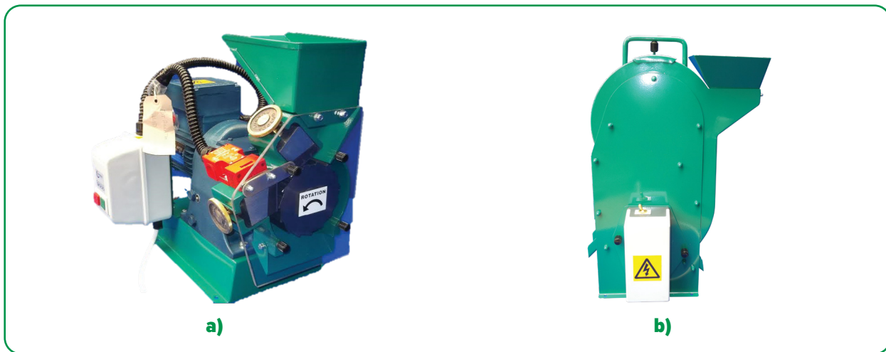
Figura 64. Apparecchiatura CAPCO in acciaio inox per a) rompere e b) vagliare i semi di cacao ( capco.co.uk ).
